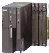
PLC/PC p. ej., Siemens S7
